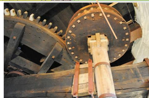
und Achsenrad sind hoch oben in der Kappe eingebaut. Damit sie sich leicht in den Wind bringen lässt, läuft sie auf eisernen Rollen. Die Lager, Rollkränze genannt, waren früher aus hartem Eichenholz gefertigt und sauber in vielen Einzelstücken rundum aneinandergelegt.
